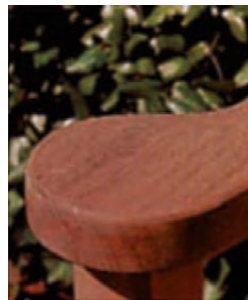
Nach einigen Wochen Das Holz verfärbt sich in eine leichte braune Farbe. Erste feine Risse können auftreten.
